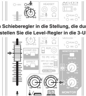
**7 Schieben Sie den Schieberegler in die Stellung, die durch eine dicke Linie markiert ist, und stellen Sie die Level-Regler in die 3-Uhr-Stellung.**
